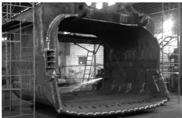
BALDE PARA UNA PALA BUCYRUS 495 B1 CONSTRUIDA EN TUCUMÁN CON DESTINO A CHILE. CAPACIDAD DE 56 M 3 Y PESO DE 60 TON. POR PRIMERA VEZ SE FABRICA FUERA DE EUA. GENTILEZA DI BACCO Y CIA SA
