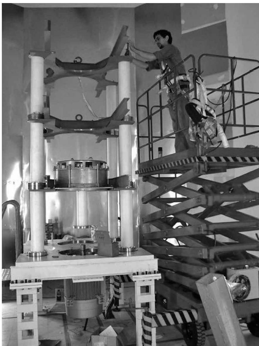
IMÁGEN 1. PROTOTIPO DE ACCELERADOR PARA BNCT EN PROCESO DE MONTAJE
